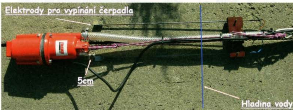
Obr. 3. ↓ Čerpadlo a provedení elektrod. Dolní konce elektrod jsou 5 cm nad úrovni sacího otvoru čer- padla, aby se čerpadlo vypnulo dříve, než začne na- sávat vzduch
